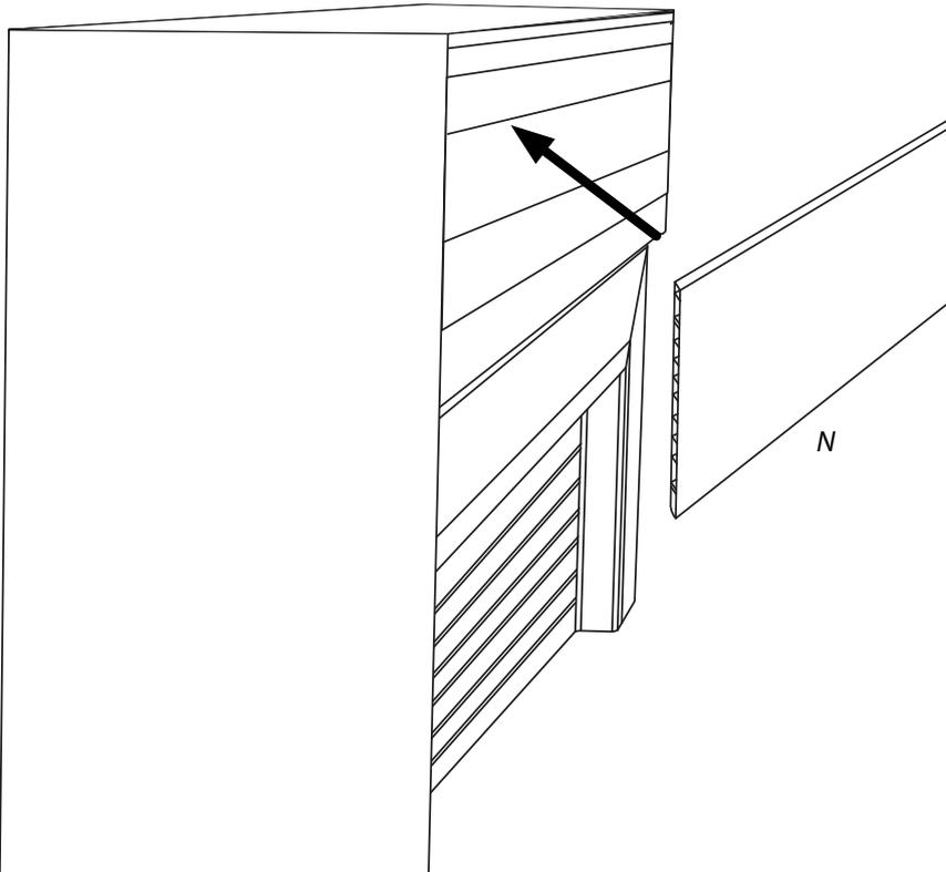
Das Kastenteil (N) vorne auf den Rollladenkasten setzen.
