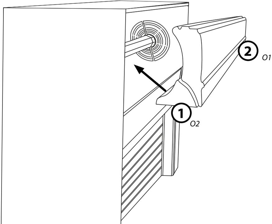
Die Dämmung (O1 & O2) vorne in den Rollladenkasten setzen.
