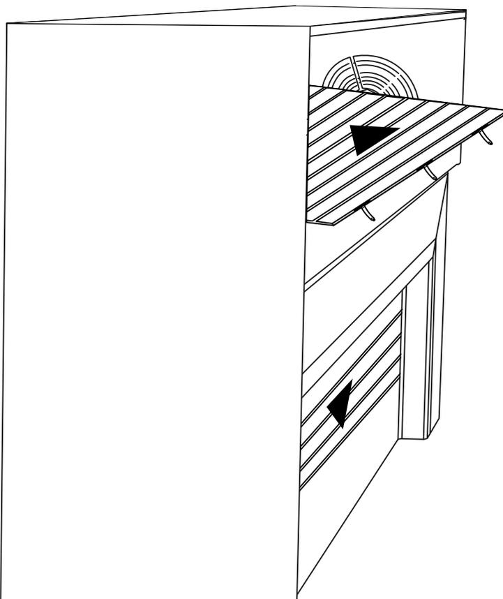
**Den Rollladenpanzer durch die vordere Öffnung des Kastens und oberhalb der Rollladenwelle in die Führungsschienen einführen!**
